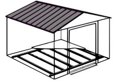
Un système de cadre de plancher simple en robuste acier galvanisé par immersion à chaud. S'utilise comme base pour le contreplaqué, le sable ou la pierre.
