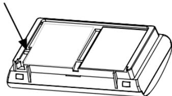
2. Une fois que l'arrière de l'unité est visible, repérez la fente élargie sur le côté inférieur gauche. Insérez un tournevis à lame plate dans la fente et faites-le glisser vers le haut de l'unité. Vous devriez sentir l'interrupteur à l'intérieur de l'unité glisser vers le haut et s'arrêter. Assurez-vous d'insérer le tournevis à angle droit et non selon un angle où vous pourriez passer à côté de l'interrupteur.
