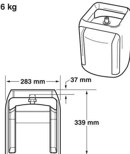
**La capacité maximale de la bouteille de gaz pour une installation à l'INTÉRIEUR du meuble est de 6 kg.**
