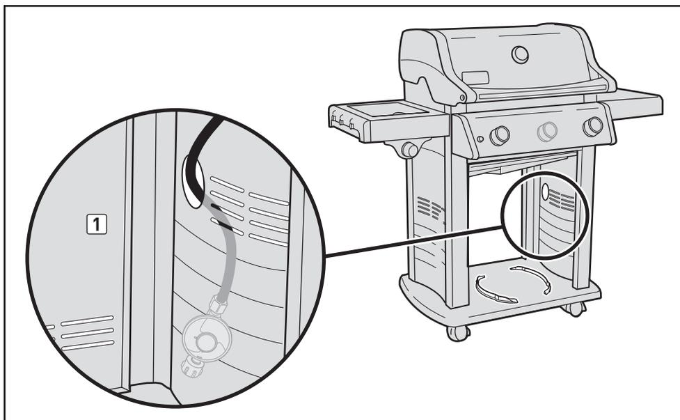
**La capacité maximale de la bouteille de gaz pour une installation à l'EXTÉRIEUR du meuble est de 13 kg.**
