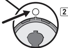
B) Assurez-vous que le robinet du brûleur latéral est fermé. Pour ce faire, enfoncez le bouton de réglage de puissance du brûleur latéral et tournez-le au maximum dans le sens des aiguilles d'une montre (2). Fermez tous les brûleurs non utilisés (○) en enfonceant les boutons de réglage de puissance correspondants et en les tournant au maximum dans le sens des aiguilles d'une montre.
