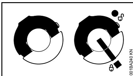
À gauche : Bouchon de réservoir à carburant – sans repères
