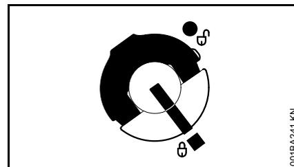
Le bouchon du réservoir est verrouillé.
