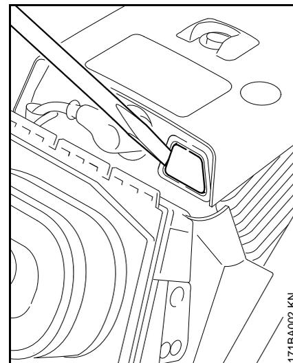
Dans des conditions hivernales extrêmes (températures inférieures à -10 °C, neige poudreuse ou soulevée par le vent), il est recommandé de casser l'obturateur du capot suivant la perforation, à l'aide d'un outil approprié.
