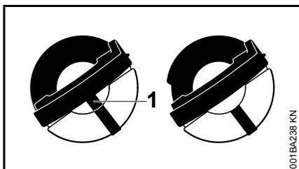
À gauche : la partie inférieure du bouchon du réservoir est décalée – le repère intérieur (1) coïncide avec le repère extérieur.
