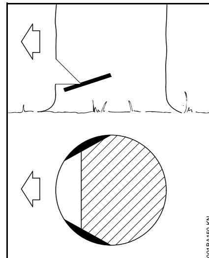
En cas de bois à longues fibres, les entailles dans l'aubier empêchent l'éclatement de l'aubier à l'abattage de l'arbre – exécuter ces entailles des deux côtés du tronc, au niveau de la base de l'entaille d'abattage, sur une largeur correspondant à env. 1/10 du diamètre du tronc – en cas de troncs de très grand diamètre, exécuter des entailles d'une profondeur maximale égale à la largeur du guide-chaîne.
