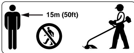
Il existe un risque d'accident en cas d'éjection d'objets dans une large zone autour de l'espace de travail, vous devez donc vous assurer qu'il n'y a personne dans un rayon de 15 m de la machine. Cette distance doit également être maintenue par rapport aux objets (véhicules, vitres) – **risque de dommages matériels !** Même à des distances supérieures à 15 m, le danger ne peut être exclu.
