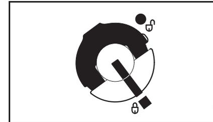
Le bouchon de réservoir est verrouillé.
