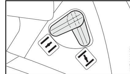
**Volet de starter fermé** **|↘|** – pour la mise en route du moteur
