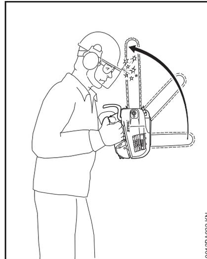
En cas de rebond (kick-back), la tronçonneuse est brusquement projetée vers l'utilisateur en décrivant un mouvement incontrôlable.
