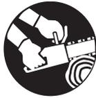
**Tenir fermement la tronçonneuse à deux mains – grand risque d'accident** : main droite sur la poignée de commande – ceci est également valable pour les gauchers. Pour pouvoir guider la machine en toute sécurité, empoigner fermement la poignée tubulaire et la poignée de commande en les entourant avec les pouces.
