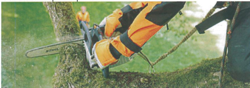
Ces tronçonneuses d'élagage aussi appelées « top handle » avec poignée de commande sur la partie supérieure de la machine doivent être utilisées exclusivement par des opérateurs expérimentés, conscients des risques spécifiques inhérents à ce type de tronçonneuse.
