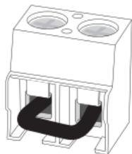
Si un pont ("shunt") est présent sur les connecteurs cela indique qu'il n'y a pas de contrôleur branché. Débranchez ce pont et installez les câbles contrôle chaudière du module FLAM dans les connecteurs.
