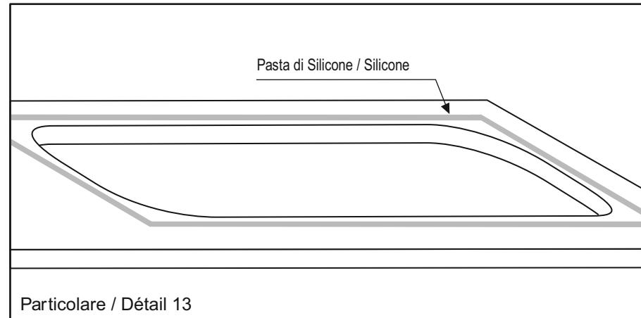
**F** Poser le plan de travail (L) déjà percé sur deux tréteaux. Appliquer les bandes de silicone autour de l'évier. Voir détail 13. Monter les crochets (gl), qui se trouvent dans l'emballage de l'évier, sur les perçages se trouvant sur les bords de l'évier (N). Voir détail 14.
