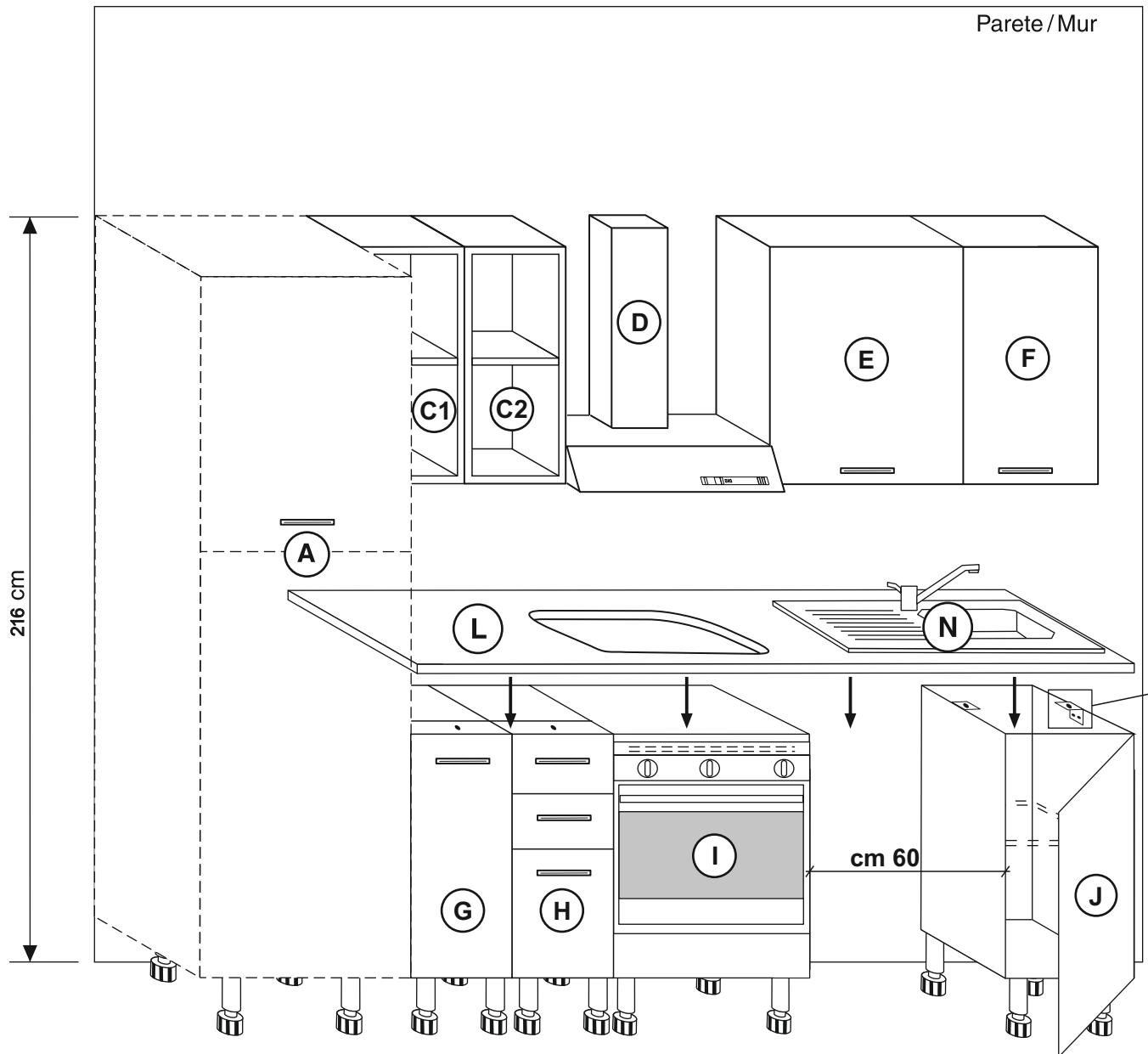
**F** Visser sur les côtés intérieurs gauche et droit du meuble sous-évier (J) les 2 équerres de fixation (avec les vis 4x18 mm.). Voir détail 21. Positionner le plan de travail (L) avec l'évier et la plaque de cuisson, au dessus des joues, en le collant au mur et à la colonne réfrigérateur (A). Fixer le plan de travail (L) aux joues à l'aide des équerres de fixation (sq) et les vis 4x18 mm.
