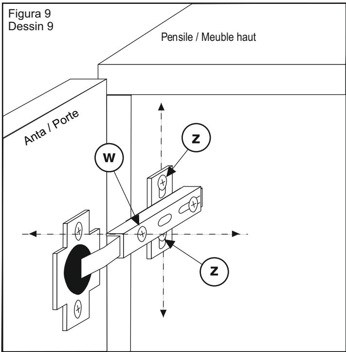
**F** Pour régler les portes en hauteur, desserrer les vis (z) et pousser les bases des charnières vers le haut ou vers le bas.
