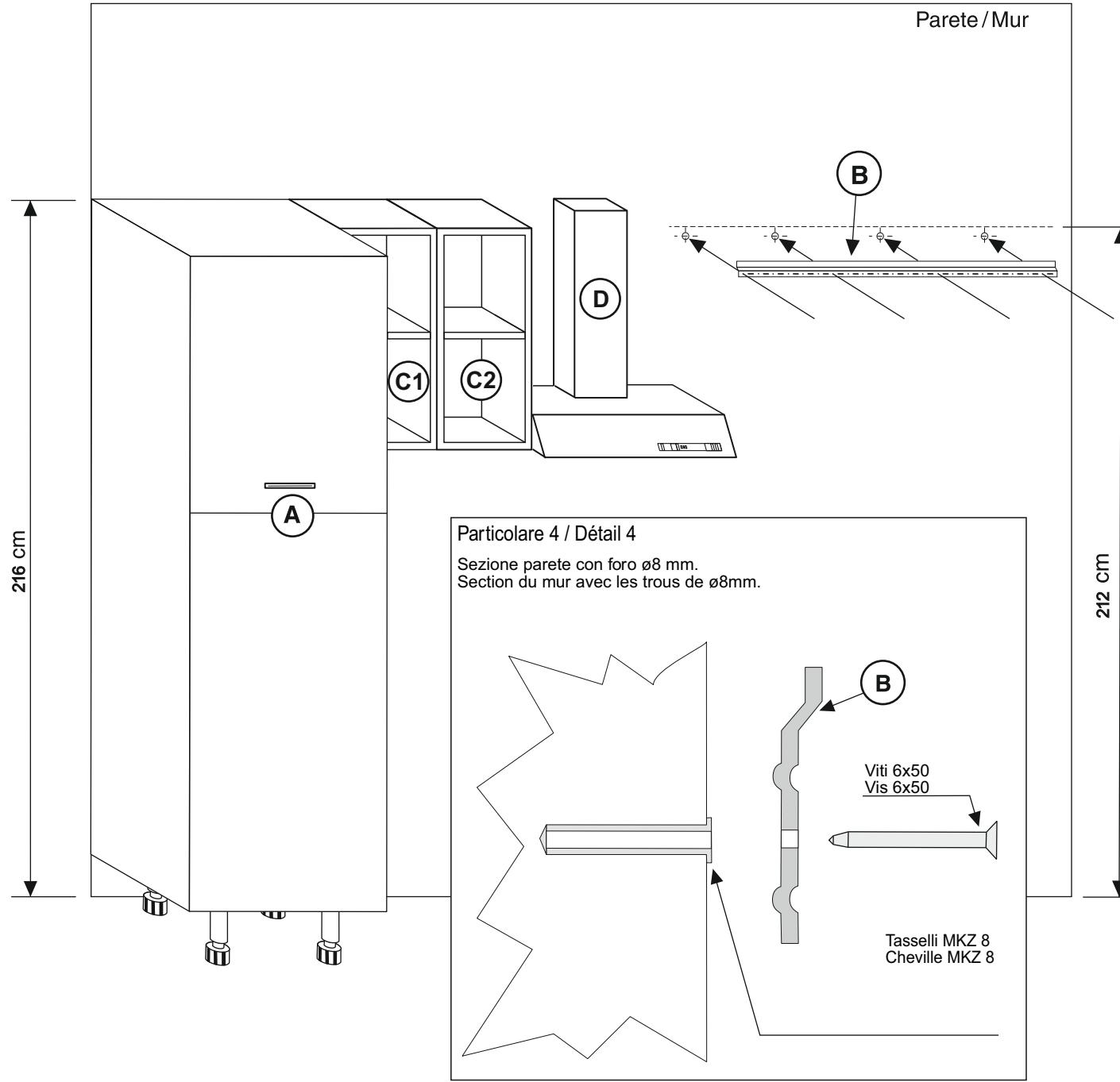
**F** Tracer sur le mur une ligne droite à une hauteur de 212 cm.
