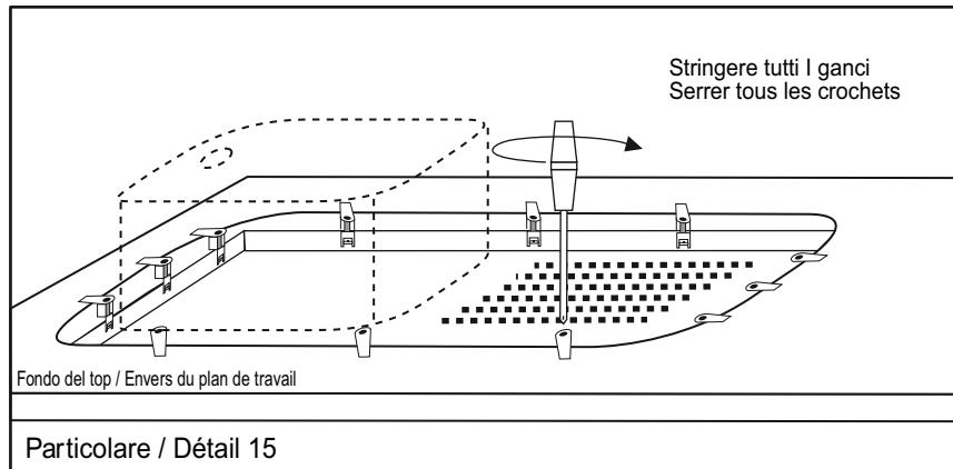
**F** Mettre l'évier sur le plan de travail (L), tourner les crochets vers l'extérieur de l'évier (N) . Il sera fixé en mettant en tension les crochets (gl). Voir détail15. Enlever avec un cutter l'excédant de silicone sur le face supérieure du plan de travail (Voir détail 16).
