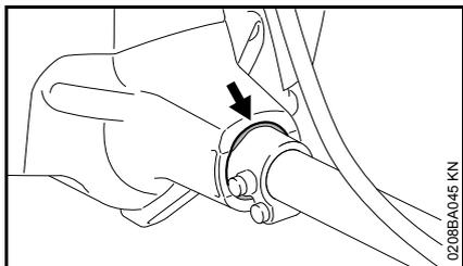
Un élément en caoutchouc amortissant les vibrations est intercalé entre l'ensemble moteur et le tube. Le faire vérifier s'il présente des traces d'usure visibles ou si une élévation permanente du taux de vibrations devient perceptible.
