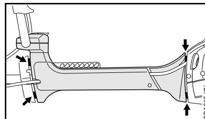
Quatre éléments amortissant les vibrations (flèches) sont intercalés entre l'ensemble moteur et le tube. Les faire vérifier si une élévation permanente du taux de vibrations devient perceptible.
