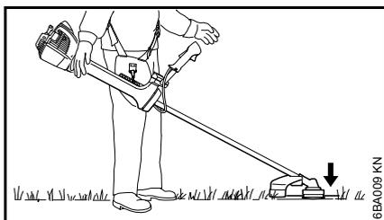
Les têtes faucheuses, les couteaux à herbe, les couteaux à taillis et le couteau de broyage doivent légèrement porter sur le sol.
