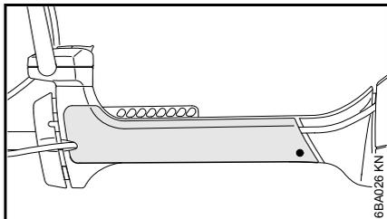
Un patin anti-usure aisément remplaçable se trouve sur le côté du carter du système antivibratoire. Au cours du travail, ce patin anti-usure peut s'user sous l'effet des mouvements de la machine frottant sur la plaque latérale du harnais. Le cas échéant, il peut être remplacé.
