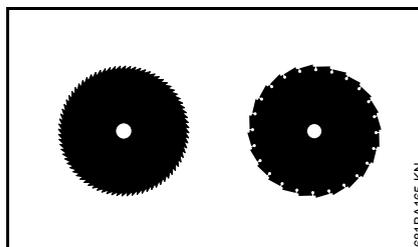
Les tranchants des scies circulaires doivent être orientés dans le sens des aiguilles d'une montre.
