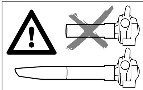
N'utiliser la machine qu'avec le tube d'aspiration intégralement monté et le sac de ramassage monté et fermé – **risque de blessure !**
