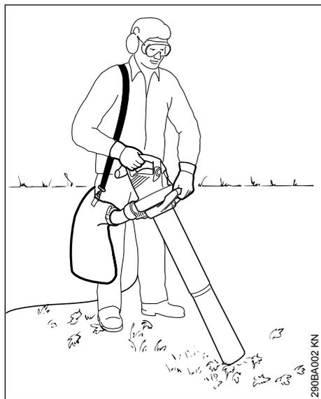
L'aspiro-broyeur est conçu pour être manié à deux mains. L'utilisateur doit tenir la poignée de commande de la main droite et la poignée de l'écrou-chapeau de la main gauche.
