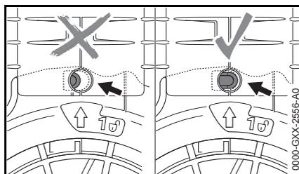
Lorsque le montage est correct, l'arrêt (flèche) n'est pas enfoncé.
