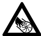
Risque de blessure par la turbine en rotation. Avant de démonter la grille de protection, le tube d'aspiration, le tube de soufflage ou le raccord coudé, il faut toujours arrêter le moteur et retirer la fiche de la prise du secteur. Attendre que la turbine soit arrêtée.
