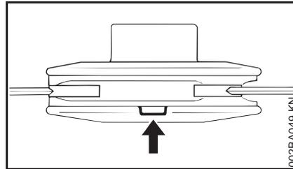
Si, sur la tête faucheuse PolyCut, l'un des témoins d'usure est cassé, du côté inférieur (flèche) : ne plus utiliser cette tête faucheuse, mais la remplacer par une tête faucheuse neuve ! **Risque de blessure** par des éclats de l'outil projetés !
