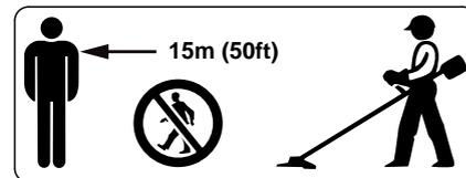
La machine peut projeter des objets à une grande distance de l'aire de travail. C'est pourquoi, à part l'utilisateur, personne ne doit se trouver dans un rayon de 15 m de la machine en marche. Respecter également cette distance par ex. par rapport à des véhicules garés, vitres etc. – **pour éviter de causer des dégâts matériels !** Même à une distance de plus de 15 m, des objets projetés peuvent encore présenter des risques.
