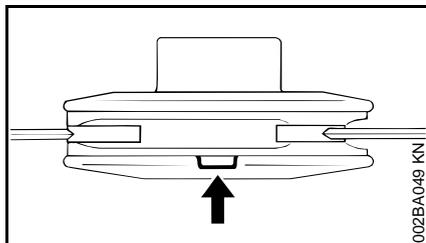
Als van de maaikop PolyCut een van de markeringen aan de onderzijde is doorgebroken (pijl): de maaikop niet meer gebruiken en vervangen door een nieuwe! **Kans op letsel** door contact met de weggeslingerde gereedschapsdelen!
