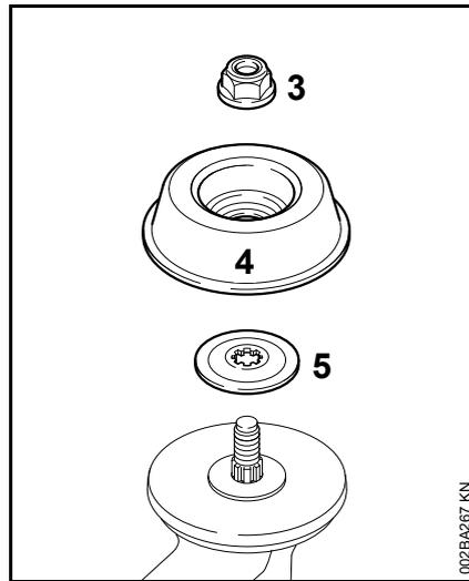
Per fissare alcune teste falcianti e lame tagliaerba sono inoltre necessari il dado (3), il piattello girante (4) e il disco di pressione (5).
