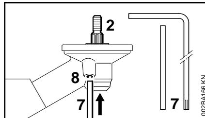
Per montare e smontare gli attrezzi di taglio, occorre bloccare l'albero (2) con la spina ad innesto (7) oppure con il
