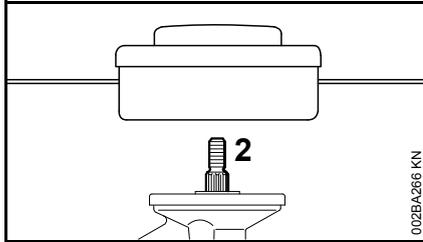
Si possono montare solo teste falcianti che si fissano direttamente sull'albero (2).
