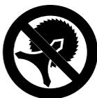
De beschermkap niet in combinatie met slagmesen en cirkelzaagbladen gebruiken.
