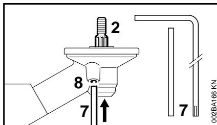
Pour le montage et le démontage des outils de coupe, il faut bloquer l'arbre (2) à l'aide du mandrin de calage (7) ou du tournevis coudé (7). Les pièces font
