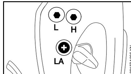
Il carburatore dell'apparecchiatura è tarato in produzione in modo tale che al motore arrivi una miscela aria/carburante ottimale in tutte le condizioni di esercizio.
