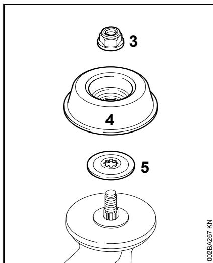
Voor de bevestiging van enkele maaikoppen en de grassnijbladen zijn ook de moer (3), de draaischotel (4) en de drukring (5) nodig.
