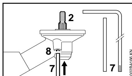
Zum An- und Abbauen der Schneidwerkzeuge muss die Welle (2) mit dem Steckdorn (7) oder dem Winkelschraubendreher (7) blockiert werden.
