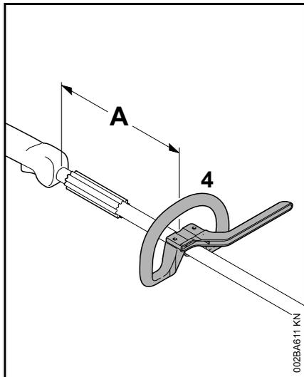
Door het wijzigen van de afstand (A) kan de beugelhandgreep in de voor de gebruiker en de toepassing meest gunstige stand worden geplaatst.
