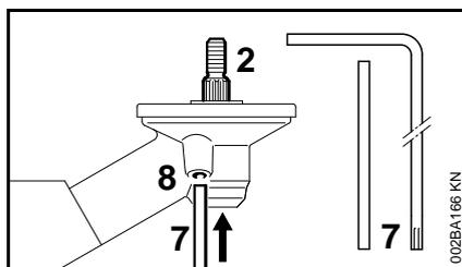
Voor het monteren en demonteren van snijgarnituren moet de as (2) met behulp van de blokkeerpen (8) of de haakse
