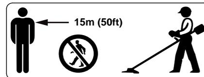
La machine peut projeter des objets à une grande distance de l'aire de travail. C'est pourquoi, à part l'utilisateur, personne ne doit se trouver dans un rayon de 15 m de la machine en marche. Respecter également cette distance par rapport à des véhicules garés, vitres etc. – pour éviter de causer des **dégâts matériels !** Même à une distance de plus de 15 m, des objets projetés peuvent encore présenter des risques.
