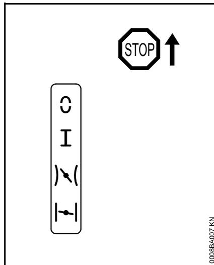
**STOP** ou  $\odot$  – pour couper le contact, il faut pousser le levier de commande universel en direction de **STOP** ou  $\odot$ . Lorsqu'on le relâche, le levier de commande universel revient en position **I**, sous l'effet de son ressort, et le contact d'allumage est automatiquement remis.
