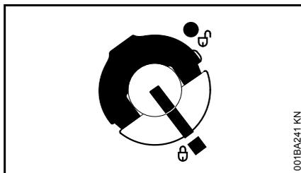
Le bouchon de réservoir est verrouillé.
