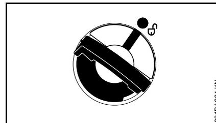
Les repères du réservoir et du bouchon du réservoir doivent coïncider.
