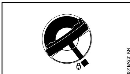
Après cela, les repères du réservoir et du bouchon du réservoir coïncident.
