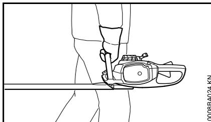
Porter la machine par la poignée – avec la barre de coupe orientée vers l'arrière. Ne pas toucher aux pièces très chaudes de la machine, en particulier au silencieux ou au carter de réducteur – **risque de brûlure !**
