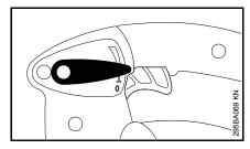
Pour la mise en route, placer le levier de réglage dans la position de marche normale T.
