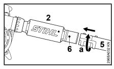
glisser la buse (5) sur le tube de soufflage (2) jusqu'au téton (6), dans la position (a), et la verrouiller dans le sens de la flèche.
