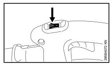
Amener le bouton d'arrêt en position 0 – le moteur s'arrête – après l'actionnement, le bouton d'arrêt revient dans la position initiale.
