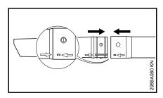
Présenter le tube d'aspiration et la rallonge du tube d'aspiration de telle sorte que les flèches coïncident, les emboîter et les faire encliqueter.
