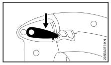
Placer le levier de réglage en position 0 – le moteur s'arrête – après l'actionnement, le levier de réglage revient dans sa position initiale.
