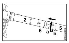
Glisser la buse (5) sur le tube de soufflage (2) jusqu'au téton (6), dans la position (a) (plus grande longueur) ou dans la position (b) (longueur réduite) et la verrouiller.
