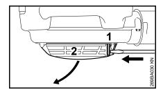
introduire un tournevis dans la languette (1) et pousser pour déverrouiller la grille de protection (2) – ouvrir la grille de protection;
