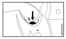
enfoncer au moins 5 fois le soufflet de la pompe d'amorçage manuelle (1) – même si le soufflet est rempli de carburant.
