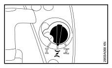
Placer le bouton du volet de starter dans la position <u>x</u>. Ce réglage est également valable si le moteur a déjà tourné mais est encore froid.
