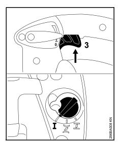
actionner brièvement la gâchette d'accélérateur (3) – le bouton tournant du volet de starter revient dans la position de marche normale I – le moteur passe au ralenti.
