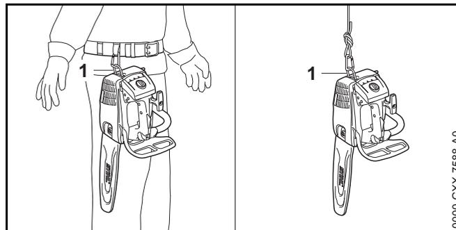
Avec l'anneau de suspension (1), la tronçonneuse peut être accrochée à la ceinture ou suspendue à un câble.
