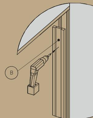
5- Poser et fixer la battue de fermeture de la porte B contre le profilé métallique de la cloison où la porte touchera en position fermée.
