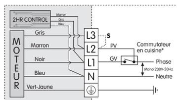
Schéma de câblage avec inverseur
