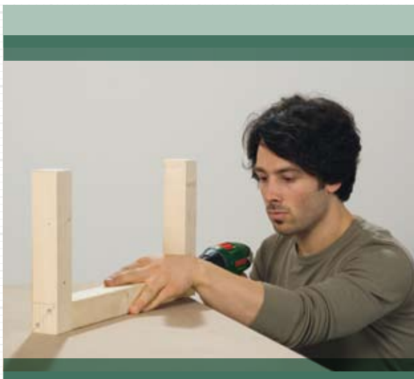
1. Assemblage des pieds et des pièces de liaison transversales pour former le châssis
