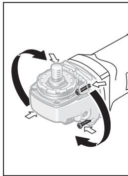
Il est possible de faire pivoter le carter d'engrenage par paliers de 90°. Ceci permet de mettre l'interrupteur Marche/Arrêt dans une position de maniement favorable à des utilisations spécifiques, p. ex. pour des travaux de tronçonnage effectués au moyen du carter d'aspiration avec glissière de guidage 19 ou pour les gauchers.
