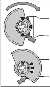
Placez le capot de protection 7 sur la fixation de l'outil électroportatif jusqu'à ce que le dispositif de codage du capot de protection coïncide avec la fixation. A cet effet, appuyez sur le levier de déverrouillage 1 et maintenez appuyé ce dernier.
