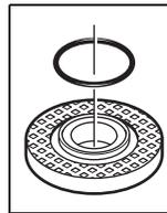
Un joint en plastique (rondelle élastique) est directement monté autour de l'alésage du flasque 8. **Au cas où cette rondelle élastique fasse défaut ou qu'elle soit endommagée, il faut absolument remplacer la flasque d'entraînement 8 avant de continuer à l'utiliser l'outil.**
