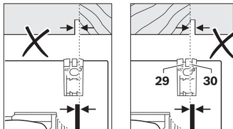
Afin d'obtenir une coupe de grande précision dimensionnelle, positionnez la scie circulaire conformément aux indications sur la figure sur la pièce à travailler. Le mieux est d'effectuer une coupe d'essai.
