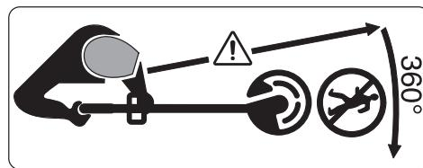
Prendre les précautions nécessaires pour que les personnes se trouvant à proximité ne risquent pas d'être blessées par des projections provenant de l'outil.
