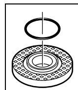
**针对 M 14 主轴的固定法兰：**在固定法兰 10 的定心轴环上有一个塑料零件 (O 形环)。如果缺少 O 形环或 O 形环损坏了，务必在继续使用之前更换固定法兰 10。
