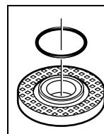
**針對 M 14 主軸的固定法蘭：**在固定法蘭 10 的定心軸環上有一個塑料零件（O 形環）。如果缺少 O 形環或 O 形環損壞了，務必在繼續使用之前更換固定法蘭 10。
