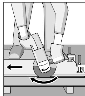
هنگام برش پروفیل ها و لوله های های چهارضلعی، بهتر است از کوچکترین ضلع مقطع برش شروع بکار کنید.
