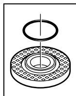
**น็อตรองจากสำหรับแกนขั้ว M 14:** ชิ้นพลาสติก (ไอ-ริง) จะติดตั้งอยู่รอบ บ่าของกลางของน็อตรองจาก 10 หาก ไอ-ริง หายหรือชำรุด ต้องเปลี่ยน น็อตรองจาก 10 ใหม่ก่อนเริ่มใช้งาน เครื่องต่อไป
