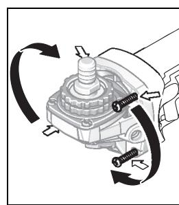
หัวเครื่องสามารถ หมุนได้เป็นชั้น ขั้นละ 90° ในลักษณะนี้ ท่าน สามารถนำลิฟท์บีด-บีดไปยังตำแหน่งที่ สะดวกต่อการใช้งาน มากกว่าสำหรับสภาพ การทำงานที่เฉพาะ เช่น ล้างหัวผู้คนน้ำซ้าย ขันสกรูทั้งสี่ด้านออก จนสุด หมุนหัวเครื่อง ไปยังตำแหน่งใหม่ ประมาณ 90° โดยไม่ต้องดึงจาก ตัวลัง ขันสกรูทั้งสี่กลับเข้าไปและยึดให้แน่น
