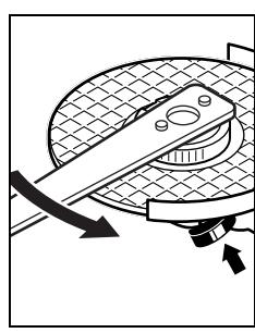
如果安裝正確，而且快速螺母未損壞的話，一般可以用手朝著逆時針的轉向擰松快速螺母。
