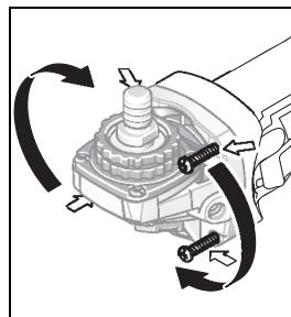
机壳上拆下机头。装回 4 个螺丝并将其拧紧。
