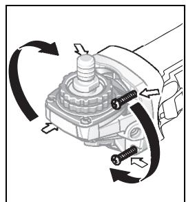
Il est possible de faire pivoter le carter d'engrenage par paliers de 90°. Ceci permet de mettre l'interrupteur Marche/Arrêt dans une position de maniement favorable à des utilisations spécifiques, p. ex. pour les gauchers. Desserrez les 4 vis et retirez-les. Faites pivoter le carter d'engrenage avec précaution et sans le désolidariser du carter machine pour le mettre dans sa nouvelle position. Resserrez à fond les 4 vis.
