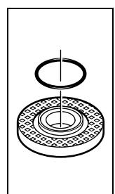
**Bích lắp cho trục máy mài có cỡ M 14:** Chi tiết bằng nhựa (vòng đệm chữ O) được lắp vào vành định tâm của bích lắp 10. Nếu vòng đệm chữ O bị mất hay bị hư, phải thay bích lắp 10 trước khi cho máy hoạt động trở lại.
