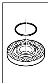
**Flens untuk poros kerja M 14:** Di dalam flens untuk poros kerja **10** di sekitar titik pemasangan ada satu bagian dari bahan sintetik (ring-O).
