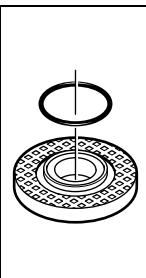
**Flasque de fixation pour broche porte-outil M 14 :** Un joint en plastique (rondelle élastique) est directement monté autour de l'alésage du flasque 10. Au cas où cette rondelle élastique fasse défaut ou qu'elle soit endommagée, il faut absolument remplacer la flasque d'entraînement 10 avant de continuer à l'utiliser l'outil.
