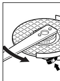
如果安装正确，而且快速螺母未损坏的话，一般可以用手朝著逆时针的转向拧松快速螺母。
