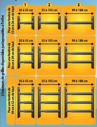
Pour plus de hauteur, ajouter 1 modèle : 1 barre pour augmenter la hauteur de 13 cm ou 2 barres pour augmenter de 26 cm ou 3 barres pour augmenter de 39 cm etc...
