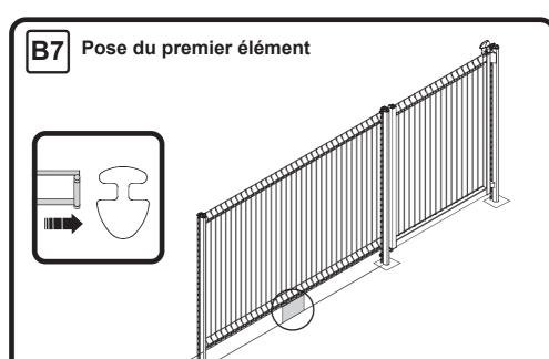
Présenter le premier module sur l'un des deux poteaux du portillon, l'introduire dans celui-ci et tirer. Vous avez la possibilité de bloquer la grille à l'aide de bloqueurs entre le poteau et le deuxième fil de la grille. Pour éviter que la grille tombe, une cale en bois de 100 mm peut être utilisée entre le sol et la grille.
