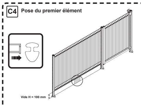
Présenter le premier module sur l'un des deux poteaux du portillon, l'introduire dans celui-ci et tirer. Vous avez la possibilité de bloquer la grille à l'aide de cales entre le poteau et le deuxième fil de la grille. Pour éviter que la grille tombe, une cale en bois de 100 mm peut être utilisée entre le sol et la grille.
