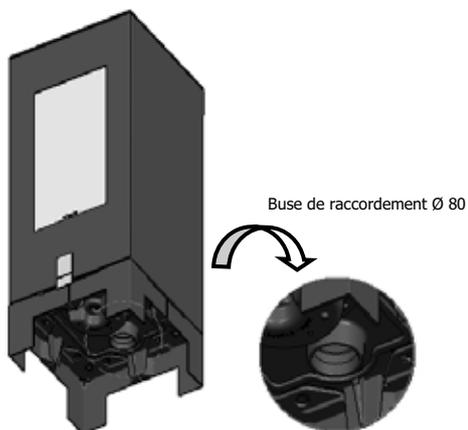
Ce poêle a été conçu pour être installé dans les maisons types BBC. Il est entièrement étanche et grâce à un raccordement (buse Ø 80), il permet de prendre l'air de combustion directement à l'extérieur sans le prélever dans la pièce. Il est compatible avec les solutions de ventilation de type VMC double flux et hydro-réglable.
