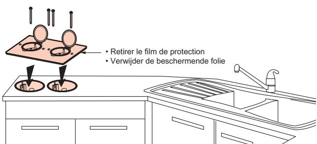
⚠ • Si cette prise est installée à moins de 1 mètre d'un point d'eau, elle doit être raccordée à un dispositif différentiel à haute sensibilité 30 mA
