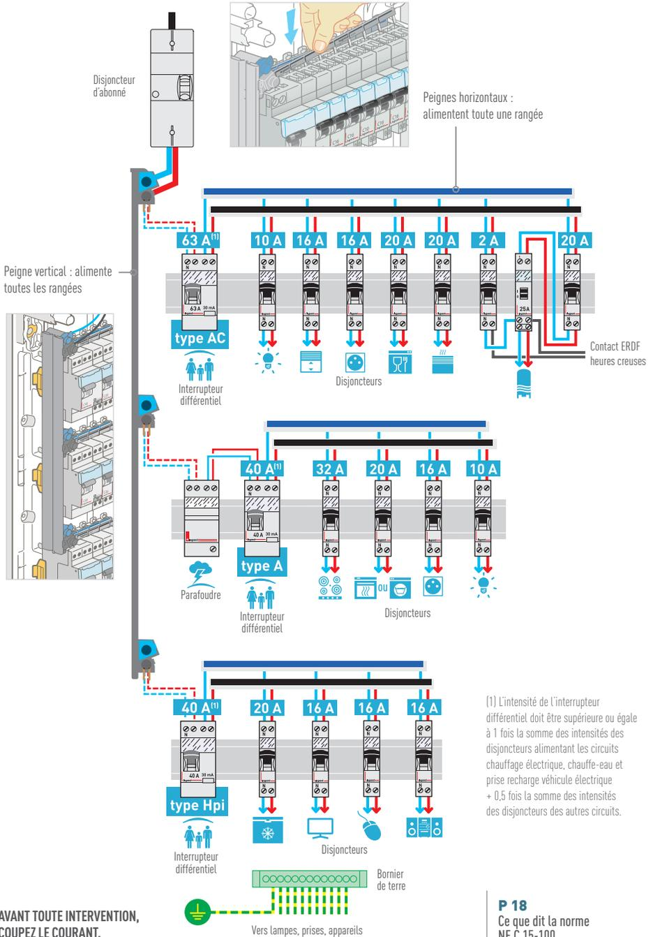
(1) L'intensité de l'interrupteur différentiel doit être supérieure ou égale à 1 fois la somme des intensités des disjoncteurs alimentant les circuits chauffage électrique, chauffe-eau et prise recharge véhicule électrique + 0,5 fois la somme des intensités des disjoncteurs des autres circuits.
