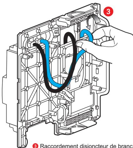
3 Raccordement disjoncteur de branchement - compteur
