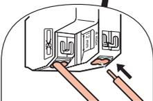
Peignage disjoncteurs avec auxiliaires (décalage 1/2 module) possible grâce au double bornage
