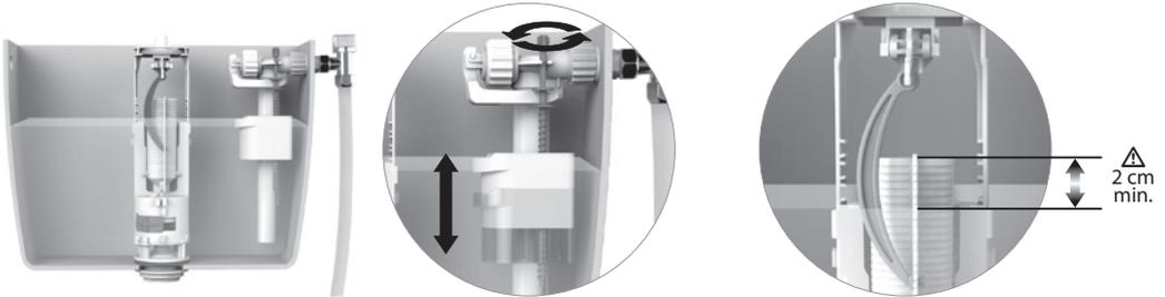
Régler le niveau d'eau à l'aide de la vis de réglage. Visser pour augmenter, dévisser pour diminuer le niveau.
