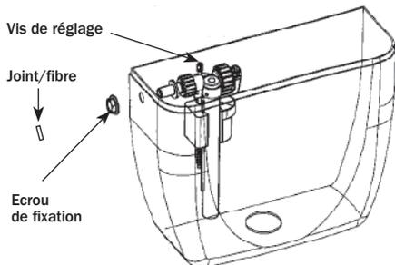
Visser à la main l'écrou du robinet jusqu'au contact de la céramique. Si nécessaire visser d'un quart de tour supplémentaire (maxi) à l'aide de la clé spécifique.
