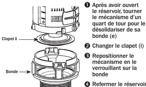
1 Après avoir ouvert le réservoir, tourner le mécanisme d'un quart de tour pour le désolidariser de sa bonde (e)
