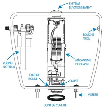
Installation du robinet flotteur à droite ou à gauche du réservoir en fonction de l'arrivée d'eau
