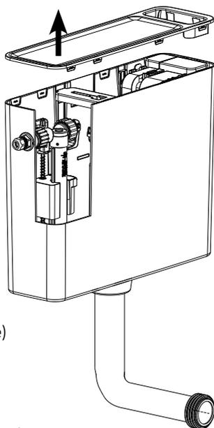
Pour accéder au filtre (pour nettoyage) ou à la membrane (pour nettoyage ou remplacement):
