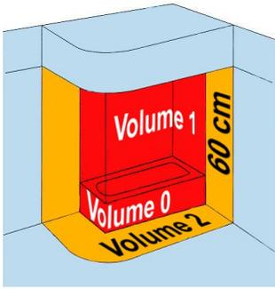
**Avertissement:** cet appareil peut être utilisé uniquement dans l'espace situé hors volume, c'est-à-dire en dehors des volumes 0, 1, 2, caché d'une salle de bain conformément aux exigences de la norme française d'installation électrique NF C 15-100.
