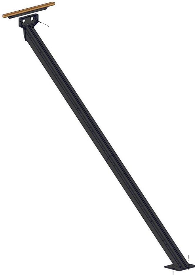
7/ Fixer le cache de la plaque de fixation haute à l'aide de la clé Allen de 3
