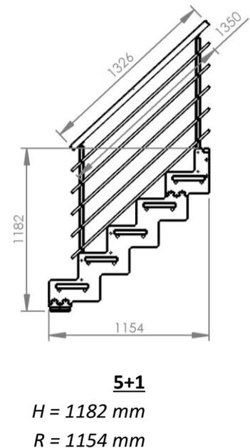
Implantation rambarde suivant recoupe **ESCA-C ¼ Tournant**
