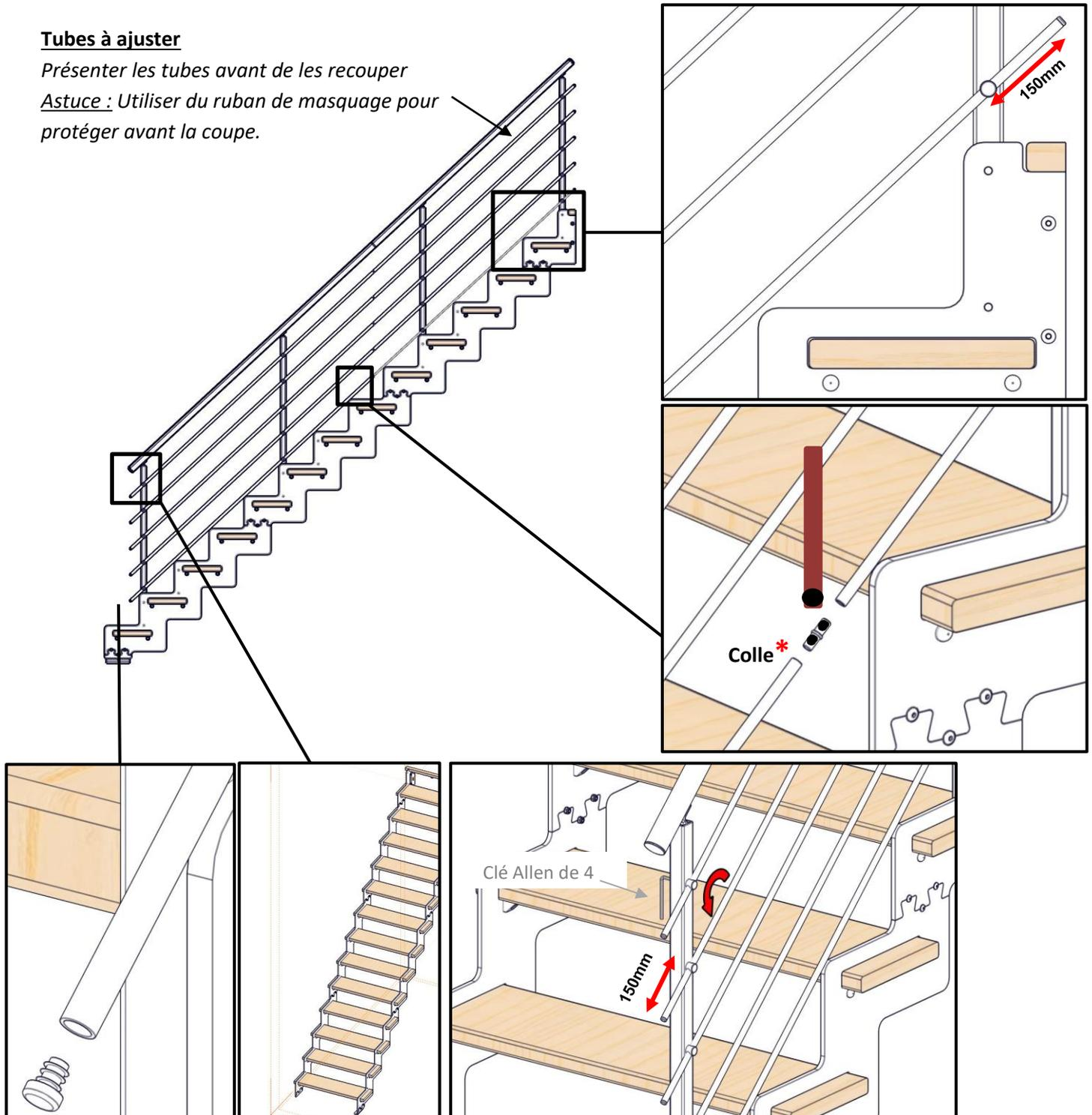
\* Mélanger puis appliquer la colle bi-composant grâce à la spatule prévue, maintenir la liaison à l'aide d'une pince lors de l'insertion de la lisse suivante.
