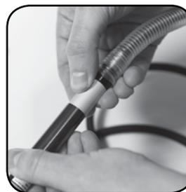
Le réglage de la vitesse s'obtient en tournant la molette située sur le manche. Tourner dans le sens des aiguilles d'une montre pour augmenter la vitesse.
