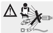
F Attention, ne jamais pointer la lance de pulvérisation sur les personnes, des animaux, des caravanes ou autres véhicules à la carrosserie légère et l'appareil lui-même ou des appareils électriques sous tension.
