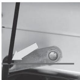
5 Remettre la tige avec le ressort, la rondelle et la goupille dans la manivelle.
