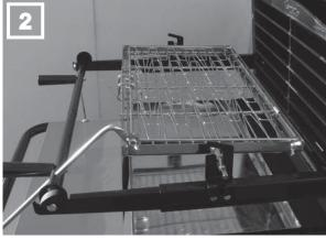
2 - Mettre la grille en position horizontale, verrouiller la vis de blocage (A).
