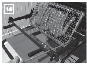
14 - Faîtes pivoter la grille double d'un demi tour en tirant sur le levier (C), verrouiller de nouveau la vis de blocage (A).
