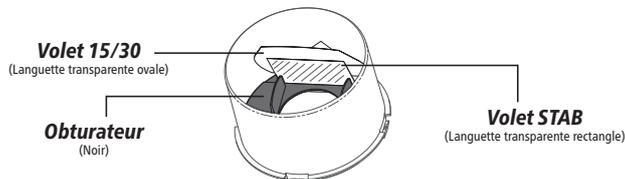
• **Attention** : quel que soit le réglage réalisé, vérifier que le «volet 15-30» soit bien en place en tirant légèrement jusqu'en butée :
