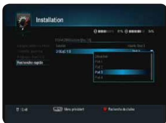
**Le paramètre DiSEqC 1.0** permet de sélectionner le DiSEqC en fonction de votre installation. (Si vous possédez par exemple une double tête avec un commutateur.
