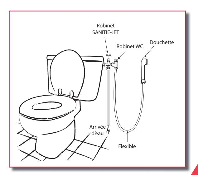
Précaution à prendre : le robinet d'arrêt en amont doit être fermé après chaque utilisation
