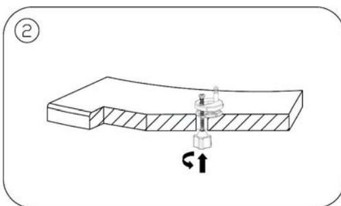
Insérez les tiges dans les trous sur le WC et serrez à moitié. N'oubliez pas les grosses rondelles, car elles empêchent la lunette de pivoter.
