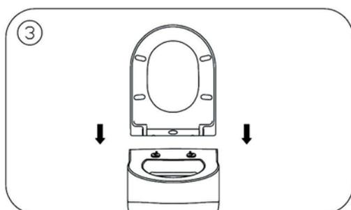
Maintenez la lunette en position verticale et positionnez les trous au-dessus des tenons. Faites glisser la lunette sur les tiges.
