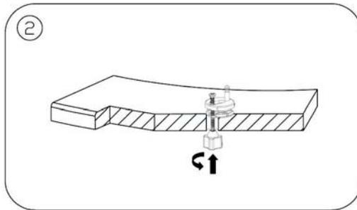
Insérez les tiges dans les trous sur le WC et serrez à moitié. N'oubliez pas les grosses rondelles, car elles empêchent la lunette de pivoter.
