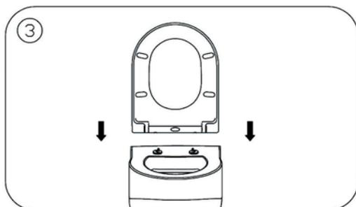
Maintenez la lunette en position verticale et positionnez les trous au-dessus des tenons. Faites glisser la lunette sur les tiges.
